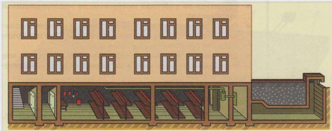
Современные убежища — это сложные в техническом отношении сооружения, оснащенные многочисленными инженерными системами, коммуникациями, приборами, которые обеспечивают условия пребывания в них людей в течение длительного времени (не менее двух суток).
