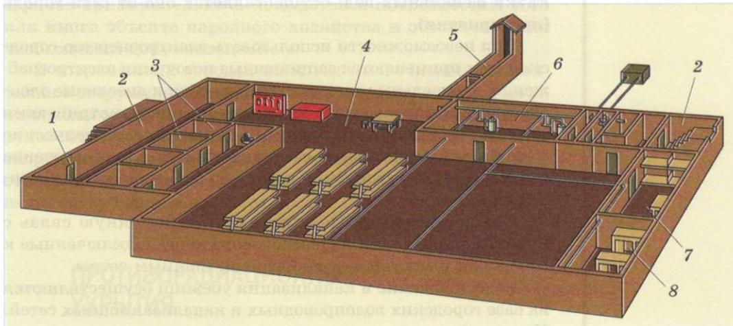
1 — защитно-термические двери; 2 — шлюзовые камеры; 3 — санитарный узел; 4 — основное помещение для размещения людей; 5 — галерея и оголовок аварийного выхода; 6 — фильтровентиляционная камера; 7 — медицинская комната; 8 — кладовая для продуктов (помещения 7 и 8 могут не устраиваться)
