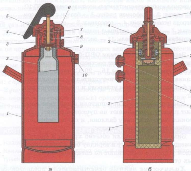
На рисунке изображены: а) химический пенный огнетушитель ОХП-10: 1 — корпус; 2 — кислотный стакан; 3 — горловина; 4 — рукоятка; 5 — крышка; 6 — прокладка; 7 — шток; 8 — пружина; 9 — клапан; 10 — спрыск; б) химический пенный огнетушитель ОП-М: 1 — корпус; 2 — кислотный стакан; 3 — горловина; 4 — крышка; 5 — шток; 6 — пружина; 7 — клапан; 8 — спрыск; 9 — предохранительная мембрана.
