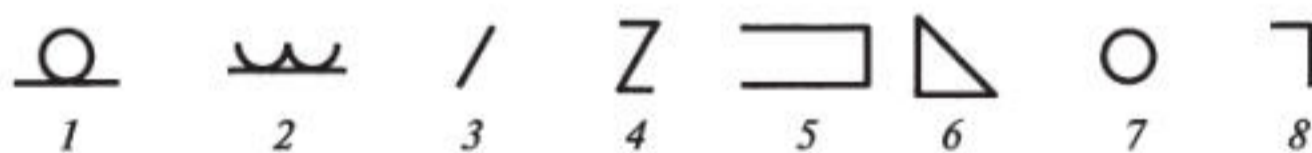
Рис. 7.13. Вспомогательные знаки в условных обозначениях сварных соединений:
