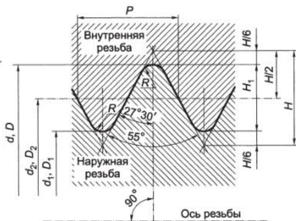
Рис. 6.15. Профиль трубной цилиндрической резьбы
