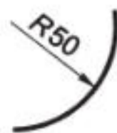
Рис. 5.21. Нанесение размера радиуса дуги, когда не требуется указывать центр
