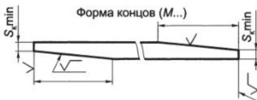
Рис. 8.24. Пружина сжатия коническая (телескопическая) из заготовки прямоугольного сечения с шлифованными на \frac{3}{4} окружности опорными поверхностями
